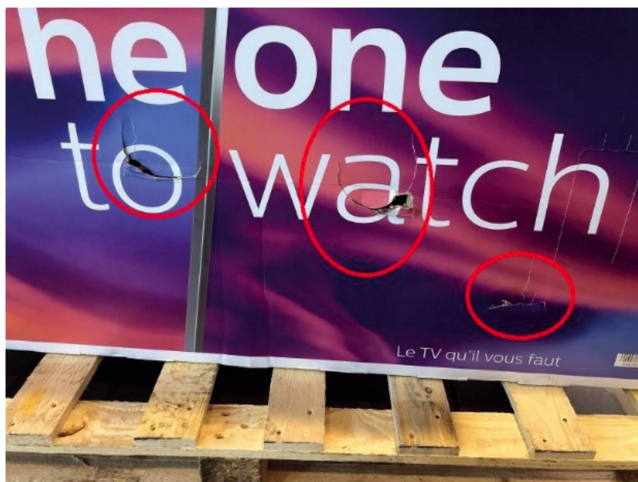
Fotografia poškodeného obalu
