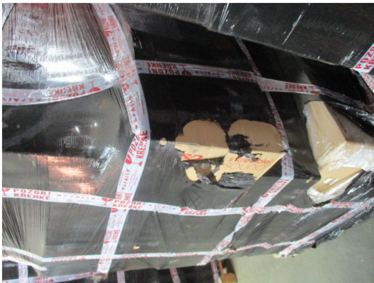
Fotografie poškození kartónu na paletě
