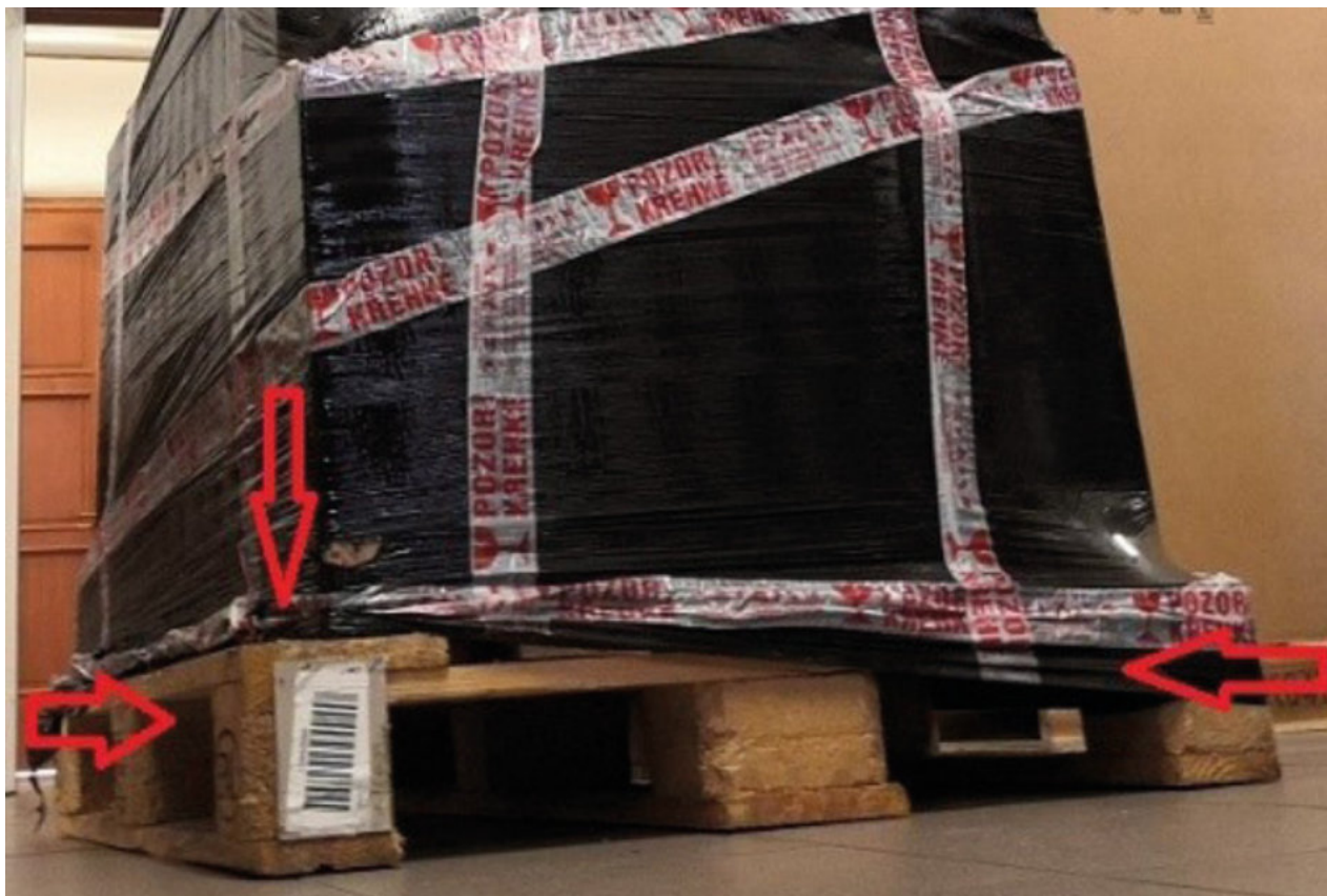
Príklad poškodennej palety, kde hrozí vykradnutie zásielky.
